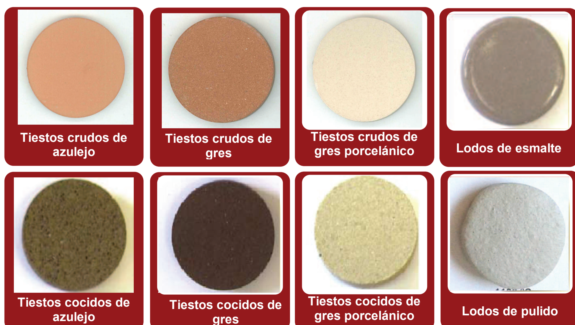
Figura 3. Probetas cocidas de los diferentes residuos.
